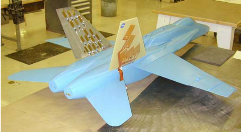
Рис. 3. - Модель истребителя с Macro Fiber Composite actuator and sensor (MFC) на килевых стабилизаторах
